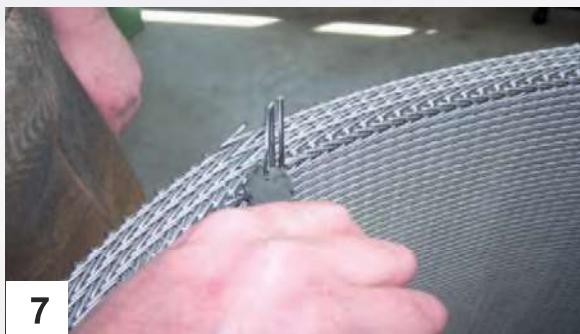
[7] Markieren Sie die Stäbe im eingeschobenen Zustand. Ziehen Sie diese wieder raus und schneiden Sie die Stäbe an den Markierungen ab.
